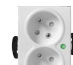
zásuvka 2x (2P+PE) s PO dvojnásobná s dětskou ochranou a přepětovou ochranou (SVĚTELNÁ SIGNALIZACE) 16 A, 250 V AC
