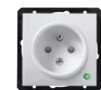
zásuvka 2P+PE s PO jednásobná s dětskou a přepětovou ochranou 16 A, 250 V AC
