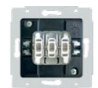
přístroj řízení 1+1+1 (3x jednopólový kontakt) 10AX, 250 V AC
