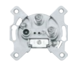
zásuvka TV+SAT+SAT průběžná, útlum 10 dB, 300 mA, 24 V DC pro koaxiální kabely průměru 4,5–8,3 mm typové označení na výrobku: ZAR-SAT 10/P3
