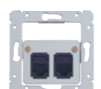
zásuvka komunikační, cat. 6 dvojnásobná 2x RJ 45 cat. 6 stíněná, pro kabel STP konektory černé
