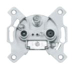
zásuvka TV+R+SAT koncová, útlum 1 dB, 300 mA, 24 V DC pro koaxiální kabely průměru 4,5–8,3 mm typové označení na výrobku: ZAR-SAT 1,4/K
